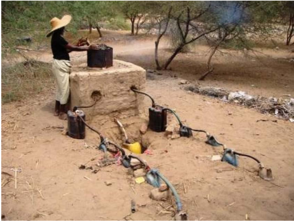
الشكل ١٢: يبين شكل الفرن وجميع الأدوات المستخدمة لاستخراج القطران الثقيل (الكثيف)
